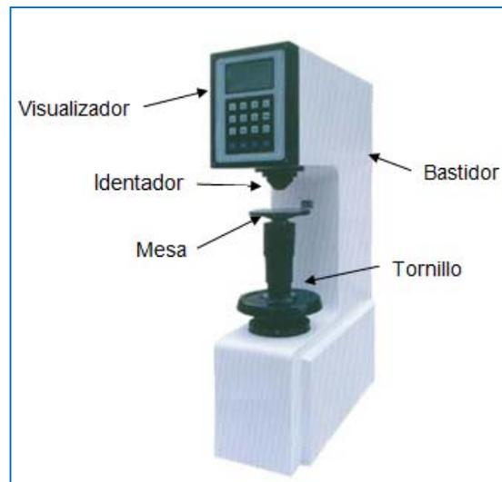
Figura 3. El durómetro y sus partes
