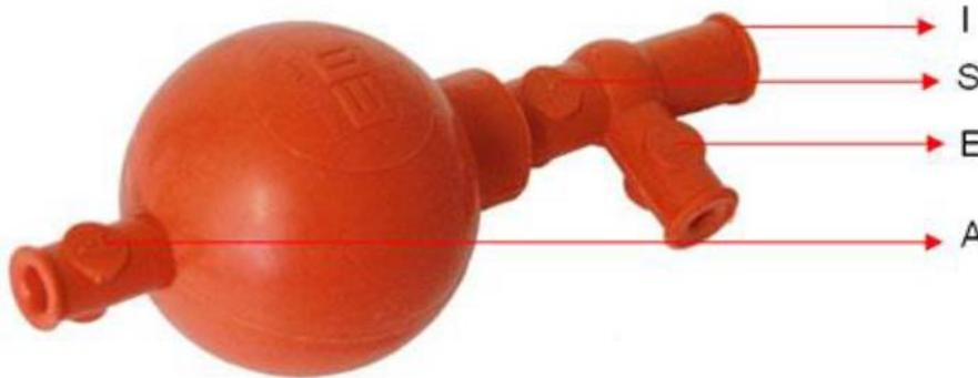
Este material se utiliza para cargar las pipetas con líquidos peligrosos para la succión con la boca (ácidos, bases).
