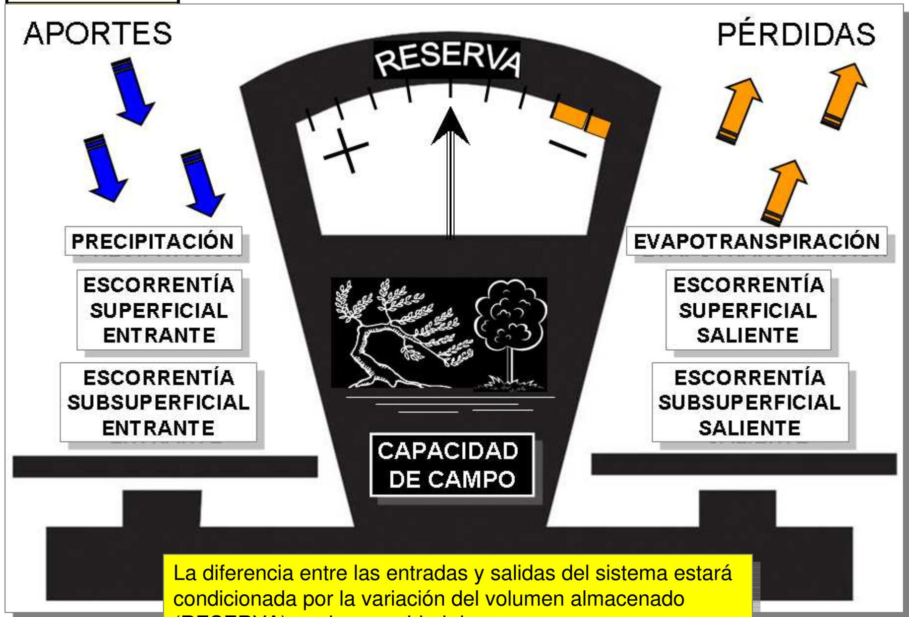
La diferencia entre las entradas y salidas del sistema estará condicionada por la variación del volumen almacenado (RESERVA) en la capacidad de campo.
