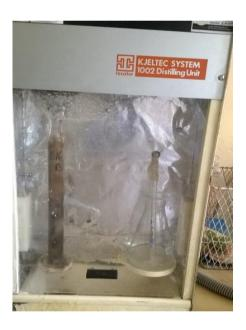
Foto N°2. Sistema de Destilación Automática
