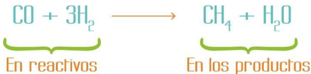
Participa 1 átomo de carbono, 1 átomo de oxígeno y 6 átomos de hidrógeno.
