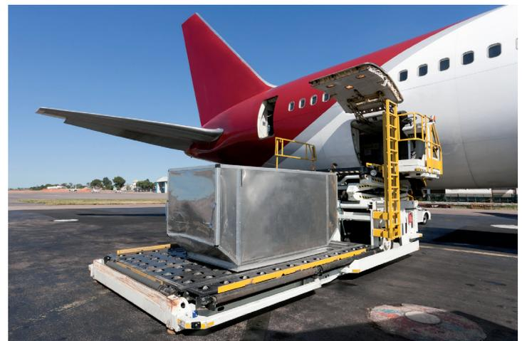
Fig. 8.11. Contenedor para transporte aéreo. Son conocidos con el nombre de iglú por sus formas, que se adaptan al fuselaje del avión.
