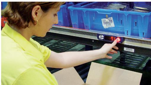
**Fig. 8.2.** Pick to light o picking por guiado óptico. Esta tecnología guía al operario visualmente hasta cada una de las localizaciones por medio de pantallas/displays de LED o LCD. Los displays situados en los racks o estanterías dirigen al operario hacia la ubicación y le indican la cantidad que debe extraer, como podemos ver en este almacén de Dematic.
