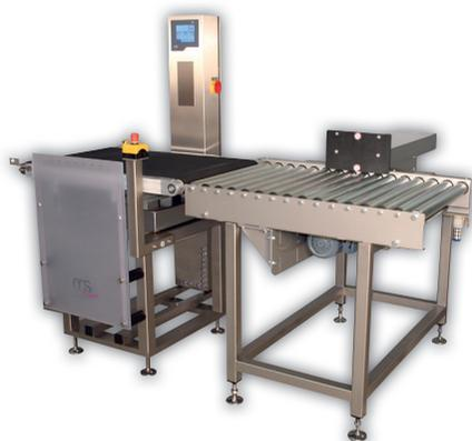
**Fig. 8.7.** Báscula industrial para el control del peso de los envíos en los procesos de expedición. En ella se compara el peso real de la unidad de expedición con el peso esperado de los productos más el del contenedor o embalaje. En caso de que la diferencia supere las tolerancias permitidas, la unidad será apartada para su revisión.
