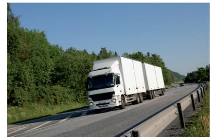
Fig. 8.9. Tren de carretera formado por un vehículo articulado (tractora y semirremolque) y un remolque. Suele utilizarse en el transporte de larga distancia.
