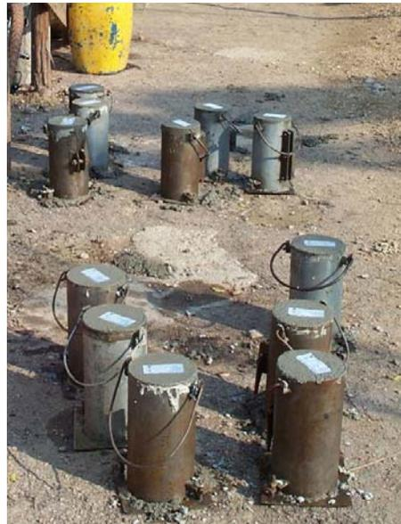
Estudio de resistencia a la compresión probetas 15\*30
