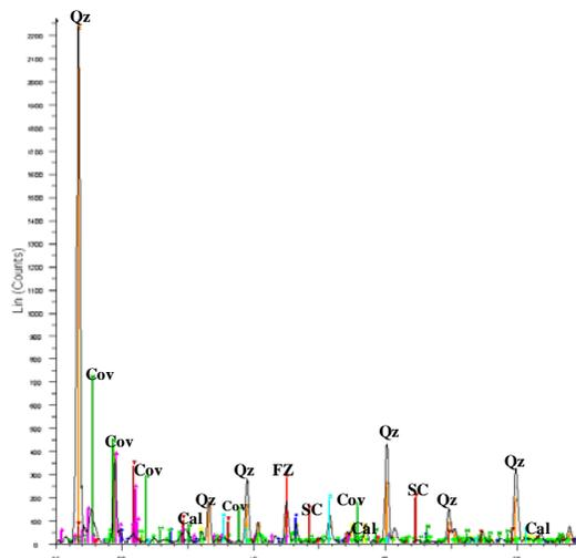
Figura 3. Espectro de Difracción de Rayos X de jales Recientes. Se observa minerales de Cuarzo (Qz), Covelita (Cov), Sulfuro cuproso (SC), Calcita (Cal) y Fierro-Zn (FZ).
