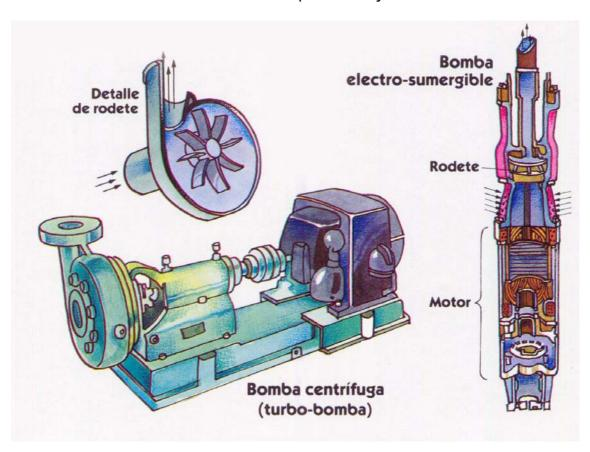
En la actualidad casi todos los sondeos se equipan con bombas "electrosumergidas". Tanto la bomba como el motor eléctrico están por debajo del nivel del agua. Los motores son especiales y pueden funcionar sumergidos.
