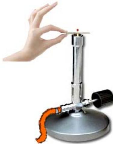
Una vez ya encendido el mechero, se observa que el palito de fósforo atravesado con el alfiler no se ha encendido, debido a que ahí se encuentra la denominada “zona fría” porque se encuentran gases sin combustionar y no existe combustión alguna.
