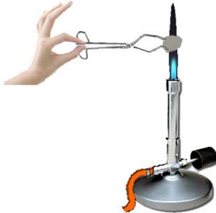
Al cabo de 10 segundos se observa que el hollín ha desaparecido, ya que ahora hay combustión completa y esta no deja residuo alguno de carbón. Al cabo de 20 segundos la porcelana llega al rojo vivo porque la llama del mechero de Bunsen ha llegado a una temperatura muy alta, ocasionando que el trozo de porcelana se caliente más rápido que en el caso anterior.
