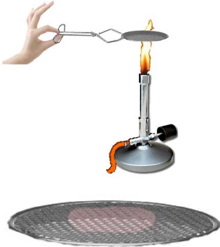
Luego se tiene el mechero con llama no luminosa, se sostiene la misma rejilla metálica, horizontalmente en la parte externa de la llama durante unos segundos. Se observa que inmediatamente la rejilla se pone al rojo vivo.
