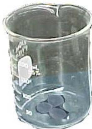
5. Se coloca en un vaso de precipitado 20 mL de agua destilada y 3 lentejas de NaOH. Luego se toma la temperatura, registrándose 22 °C.
