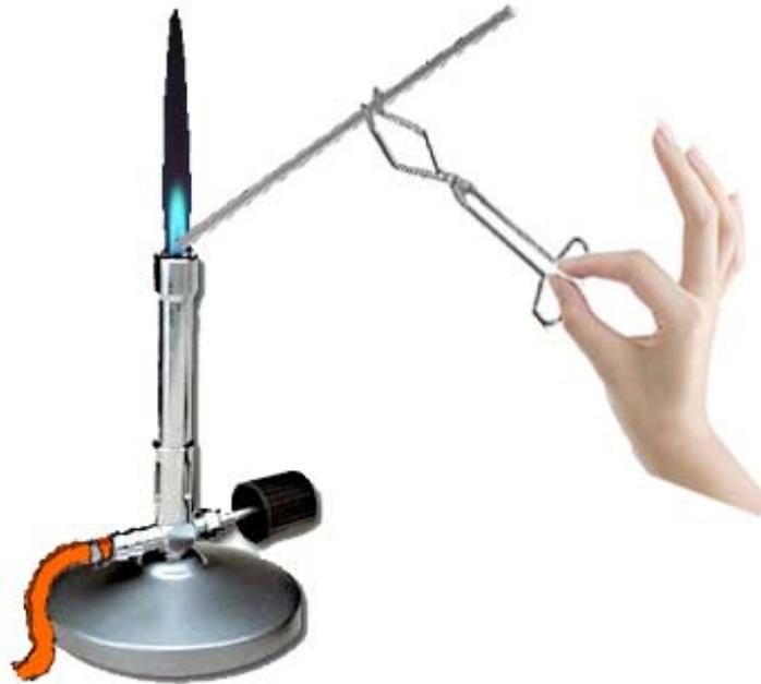
Pronto se enciende un fósforo al otro extremo del tubo de ensayo, seguidamente se enciende ese último extremo puesto que el gas sin combustionar que se encuentra en la zona fría del mechero se propaga por el tubo de vidrio alcanzando así al final del tubo de vidrio.
