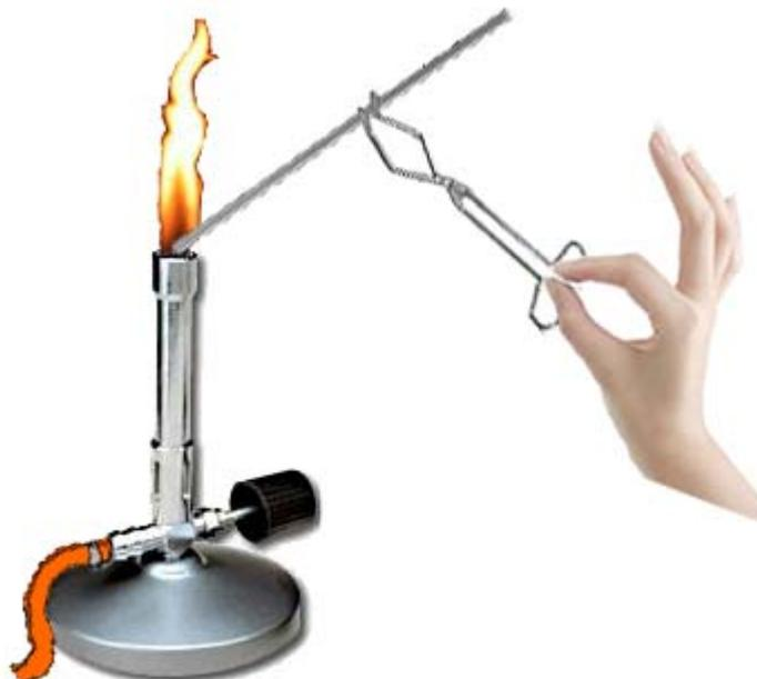
Posteriormente se coloca un fósforo encendido al otro extremo del tubo de ensayo, inmediatamente se enciende ese último extremo porque el gas sin combustionar que se encuentra en la zona fría del mechero se difunde por el tubo de vidrio llegando así al final del tubo de vidrio.
