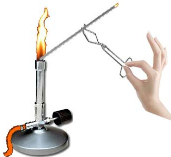
Luego se enciende el mechero con llama no luminosa, se vuelve a colocar el tubo de vidrio, sujetado con una pinza para crisol, de manera que forme un ángulo de  $45^\circ$  con la horizontal, cuyo vértice es el extremo del tubo.
