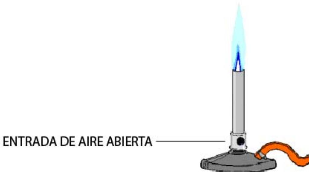
**NO ABRIR REPENTINAMENTE PORQUE PUEDE APAGARSE EL MECHERO**
