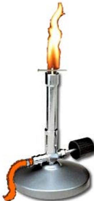
Luego se abre la entrada de aire del mechero para que esta vez sea con llama no luminosa y se vuelve a observar que el palito de fósforo tampoco se prende.
