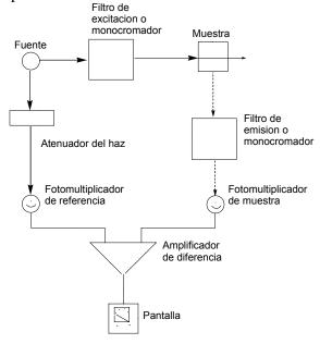
El haz de referencia pasa a través de un atenuador que reduce su potencia aproximadamente la de la radiación fluorescente. Desde los tubos fotomultiplicadores de muestra y de referencia las señales son entonces conducidas a un amplificador de diferencia cuya salida se leen un contador o un registro.
