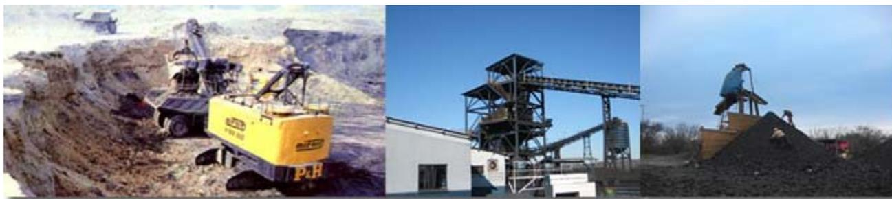
Diferentes tipos de extracción del carbón (tajo, mina subterránea y "pozo")
