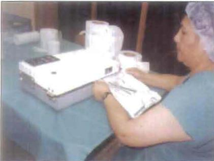
(Fig. No. 16) Se observa una selladora automática, para los empaques mixtos (Seal and peel)
