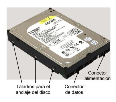
Las fotografías superiores muestran un disco duro real. Se trata de un modelo típico para PC. Tiene un diámetro de 3,5", que es el mismo que un disquete. Se monta mediante tornillos en el bastidor interno de la caja y se conecta mediante un cable, usando su conector de datos, a una interfaz interna del computador que lo integra en el sistema de buses, para que pueda comunicarse con la CPU, memoria, etc.
