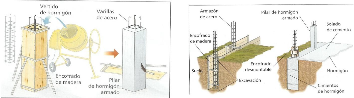
Tienes que tener en cuenta que durante el *fraguado* del cemento (el secado) se desprende mucho calor y se forman gases en el interior de los elementos construidos. Si el cemento en este proceso no se refresca (normalmente con agua), se forman grietas en la estructura por las que salen los gases y el calor. Por eso los albañiles remojan el cemento, el hormigón y el hormigón armado mientras fraguan.
