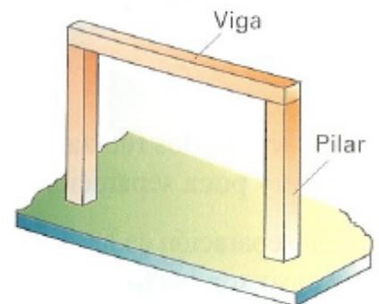
3. **Vigas:** Son elementos estructurales que normalmente se colocan en posición horizontal, que se apoyan sobre los pilares, destinados a soportar cargas. En un edificio forman parte del forjado. Ejemplos de vigas son, los rieles de las cortinas, los travesaños horizontales de debajo del tablero en el pupitre o en la silla, el marco de la ventana o de la puerta, etc.
