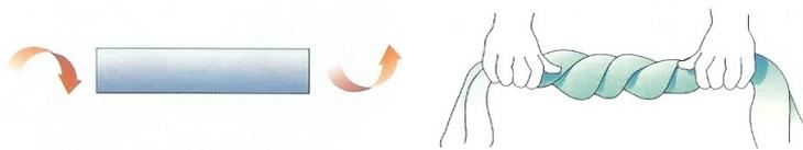
Es el tipo de esfuerzo que soporta una llave girando en una cerradura.
