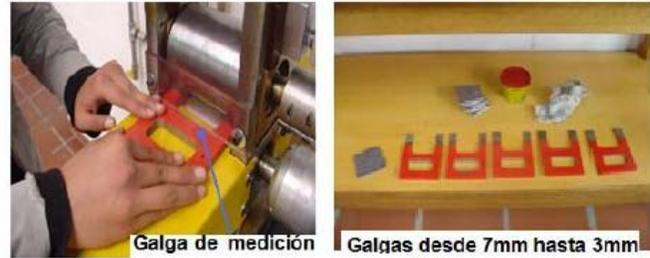
Figura 11. Galgas de medición
