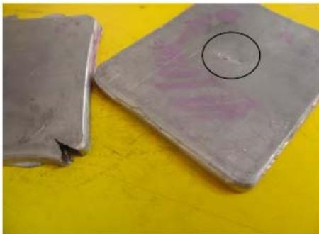
Figura 3. Láminas con presencia de grietas.
