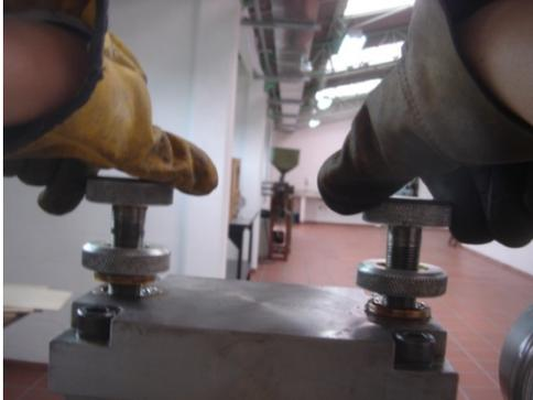
**Figura 6.** Ajuste de rodillos de laminación, utilizando los tornillos.
