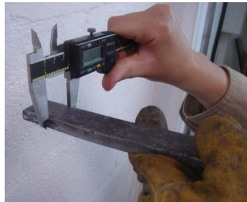
Figura 5. Medición del ancho de una lámina de estaño
