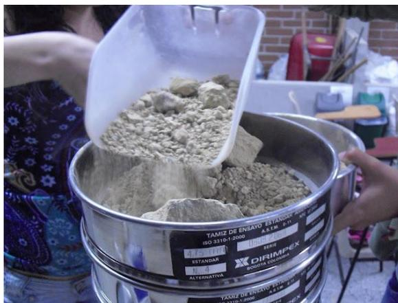
Una vez que la muestra ya está disgregada y seca, y que además ya no hay agregados presentes, se prosigue de la siguiente manera: se cuarteo de 50 a 100 gr de muestra, la cual podrá ser mayor si se utilizan muchos tamices.
