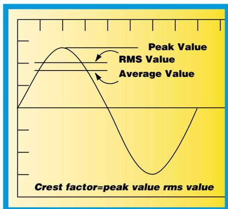
Fig.4. Los medidores que utilizan el valor medio para calcular el valor eficaz, multiplican este valor medio por un factor para dar "rms".
