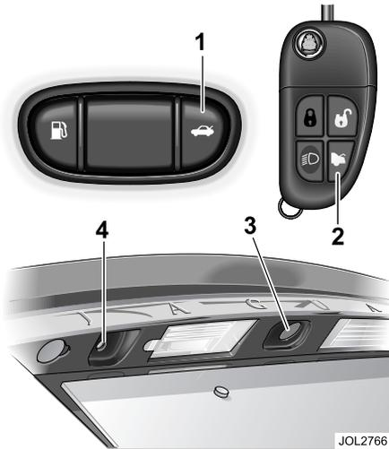
Si el sistema de alarma está activado y se abre el maletero mediante el transmisor, la alarma no sonará. El sistema volverá a activarse una vez cerrada la tapa del maletero, siempre y cuando no se haya desactivado el sistema.
