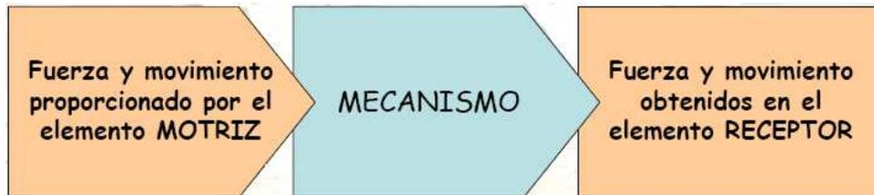
Todo mecanismo de cualquier máquina estará compuesto internamente por uno o varios dispositivos denominadas "operadores" (palancas, engranajes, ruedas, tornillos, etc.). Por ejemplo, el mecanismo de una bicicleta está formado por varios operadores, como son la cadena y los engranajes que conecta (platos y piñones).
